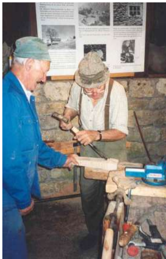
Abbildung 6 Bearbeitung der Ecken mit dem Stemmeisen.
