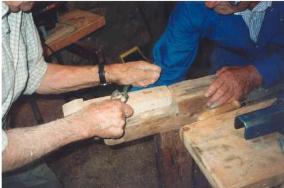
Abbildung 5 Materialabtrag mit dem Schweifhobel auf Stoß
