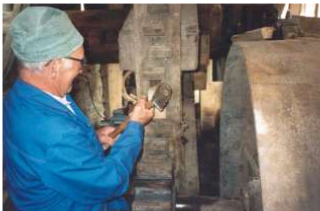
Abbildung 9 Einschlagen des Zahnes von vorne aus gesehen
